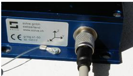
Figur 1: Anschliessen des Datenloggers
